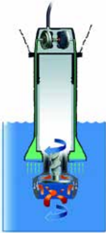
LPS pumpen lager kraftig rotasjon på vannet for å hindre sedimentering
